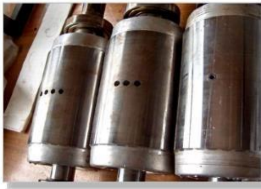
Figure I.9 Défaut de rupture de barres
