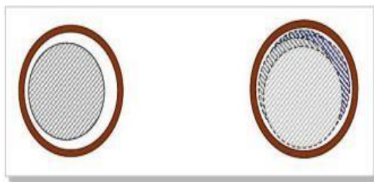
Figure I.5 Défauts d'excentricité statique et dynamique
