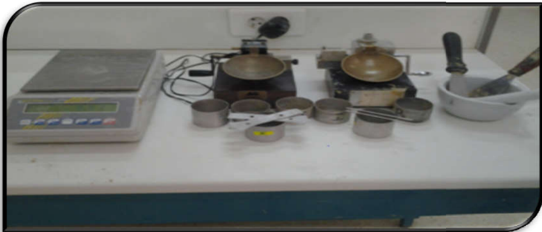
Figure II.4: Appareil de Casagrande et matériel de la limite de liquidité.
