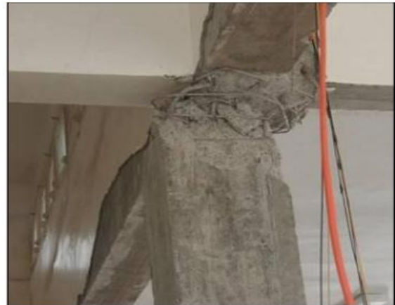
Figure II.6 Rotule dans la poutre (comportement recherché) [7]
