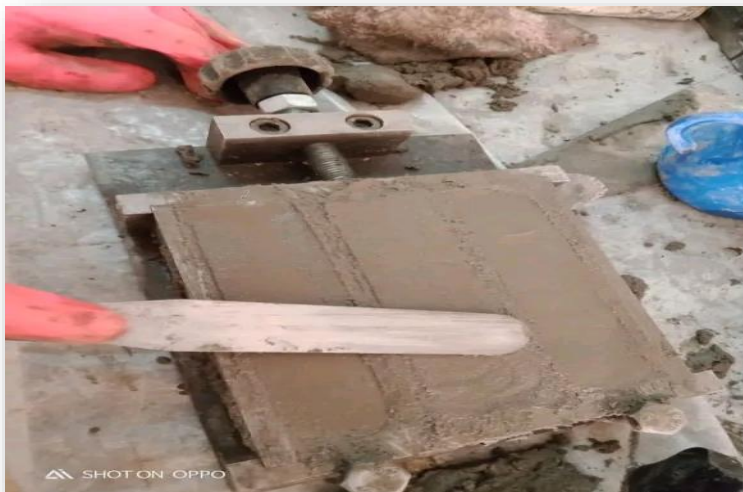
Fig. III. 12 Aplanissement des éprouvettes (Labo de génie civil M'SILA)
