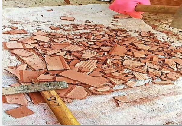
Fig. III. 6 Déchets de brique
