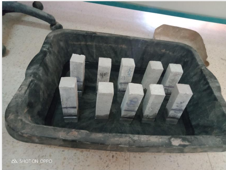
Fig. III. 16 Essai d'absorption (Labo de génie civil M'SILA)
