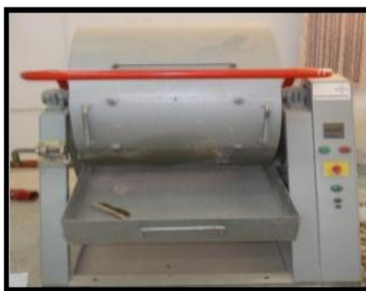
Figure. 3.5. Appareil de l'essai Los Anglos.
