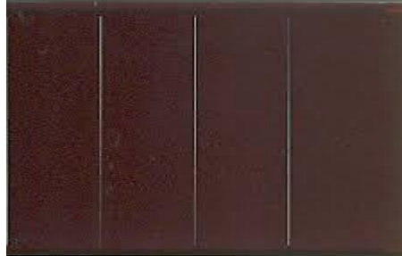
Fig. 1.14 Cellule au silicium amorphe (couche mince).
