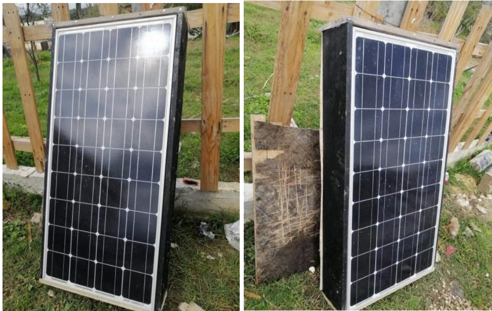
Fig. 3.8 Banc d'essai du capteur solaire PV/TH hybride à air
