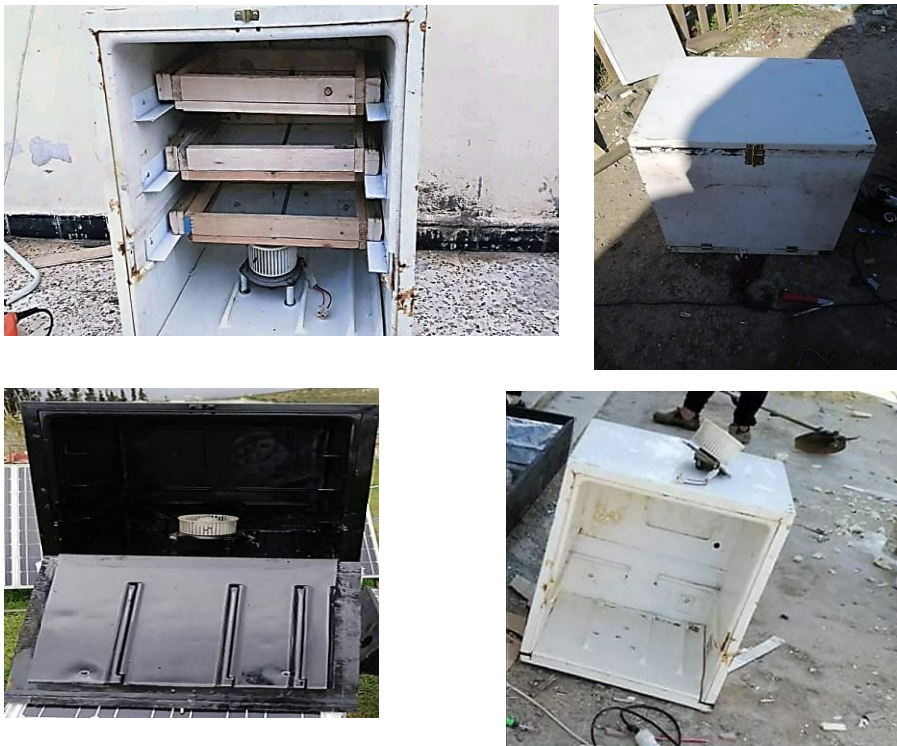
Fig. 4.5 Fabrication de cuissière.
