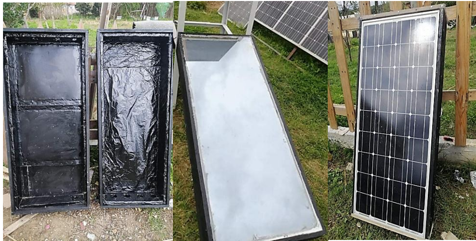
Fig. 4. 4 Élément thermique et panneau solaire avant et après fabrication
