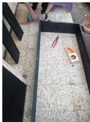
Fig.3.4 formation d'une boîte en bois rectangulaire
