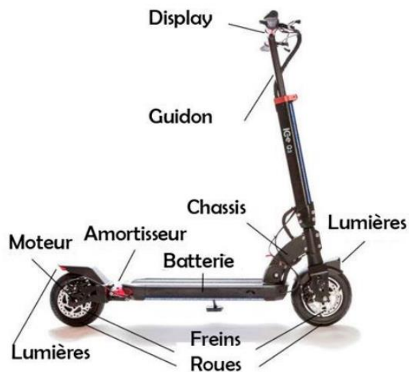
Figure I-2 : fonctionnement de la trottinette électrique
