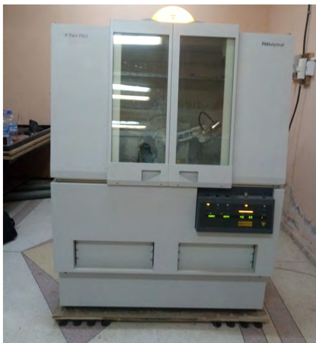
FIGURE 2.6 – Dispositif de diffraction de rayons X utilisé (Université Mohamed Boudiaf M'sila) et illustration de la technique de mesure.
