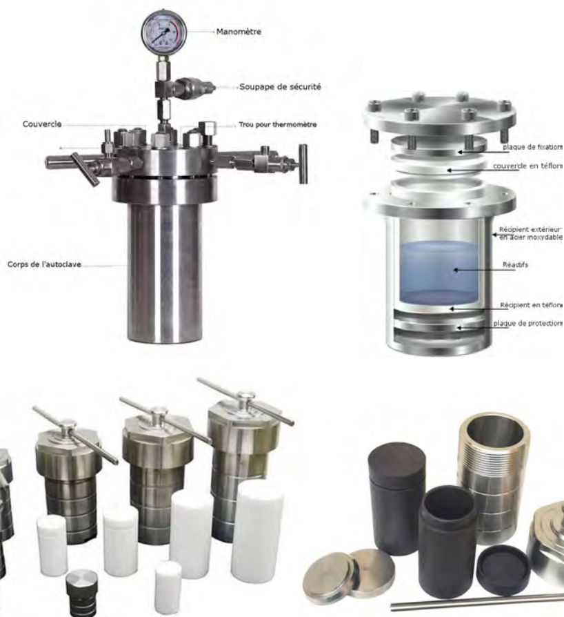
FIGURE 2.2 – Autoclaves utilisés dans les procédés hydrothermal/solvothermal
