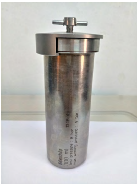
FIGURE 2.3 – Image de l'autoclave utilisé pour la synthèse de nanoparticules de ZnO
