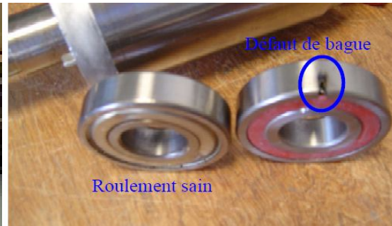
Figure I-13- Défaut sur la bague extérieure
