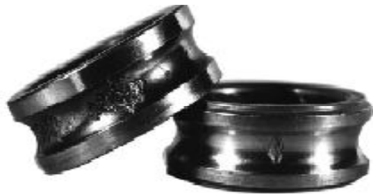
Figure I-14-Défaut sur la bague intérieure
