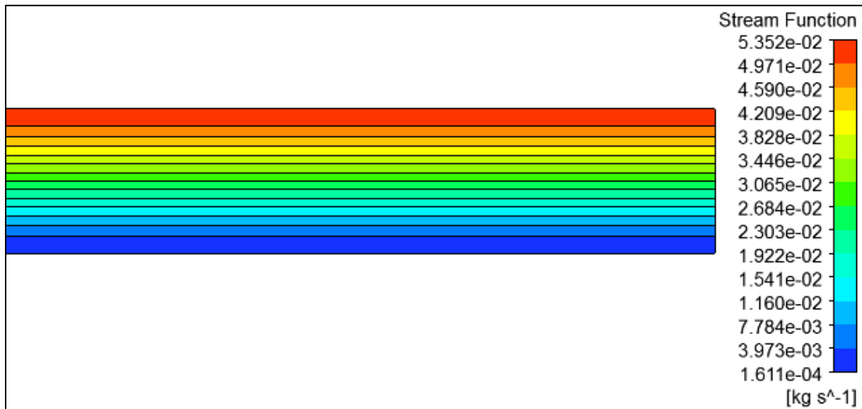
Figure IV-5: Lignes de courant à la sortie du capteur, simulé pour Re=3000 , Te=300K et G=100 \text{ W/m}^2 .
