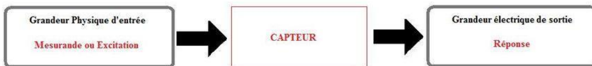
Figure 1: principe de fonctionnement d'un capteur
