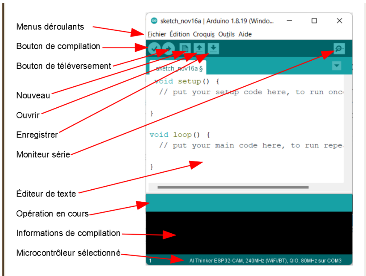
Figure 22 :interface avec les icônes Arduino IDE.
