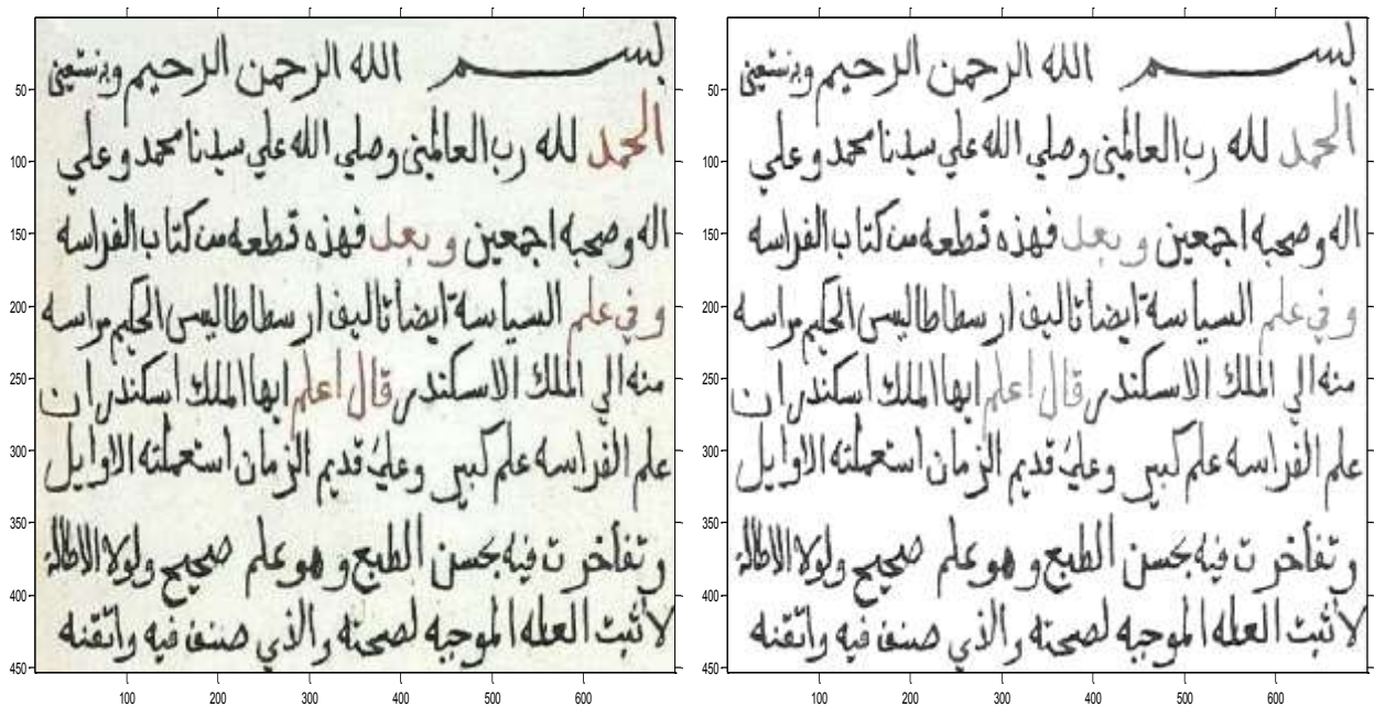
Fig. 4. 9 Image original et image débruitée final. Par OWT SURE-LET-JBF et le prétraitement par la méthode d'OTSU
