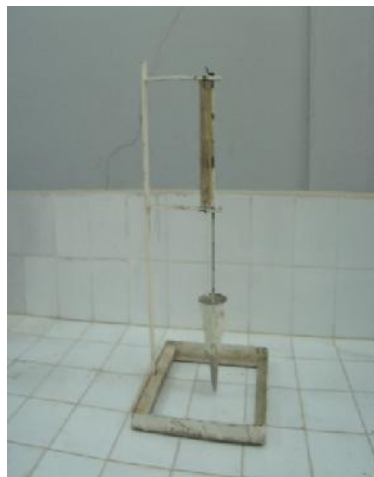
Figure III.5 : Mesure de la fluidité du mortier.
