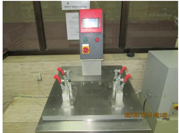
Figure III.2 : Table vibrante.
