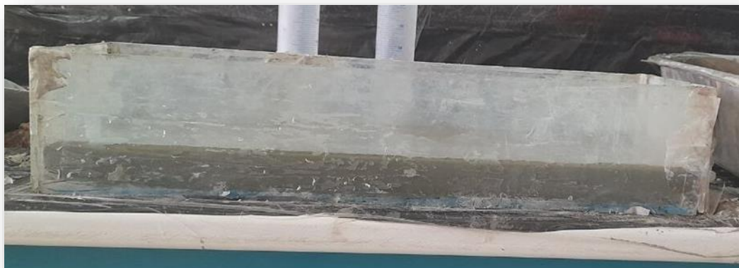
Figure (II.12) : Photo montrant la planéité de la surface libre du MAP*01.
