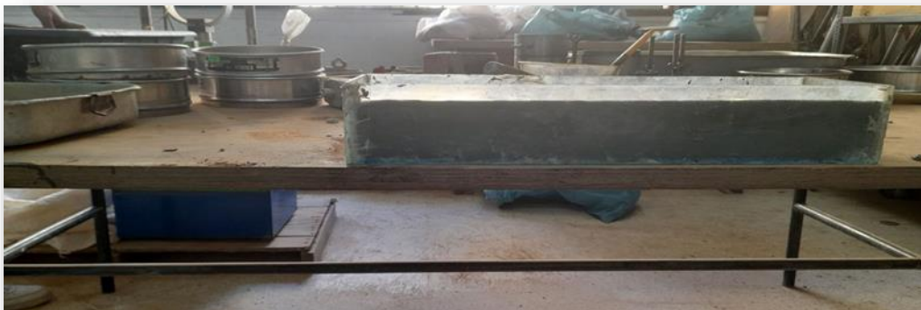
Figure (II.9) : Photo montrant la planéité de la surface libre du MAP02.
