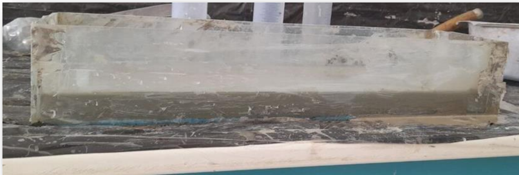
Figure (II.14) : Photo montrant la planéité de la surface libre du MAP*03.
