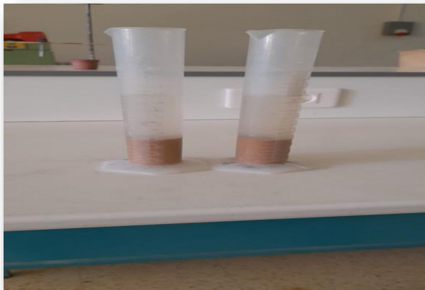
Figure (II-2): Essai équivalent de sable exécuté au laboratoire.
