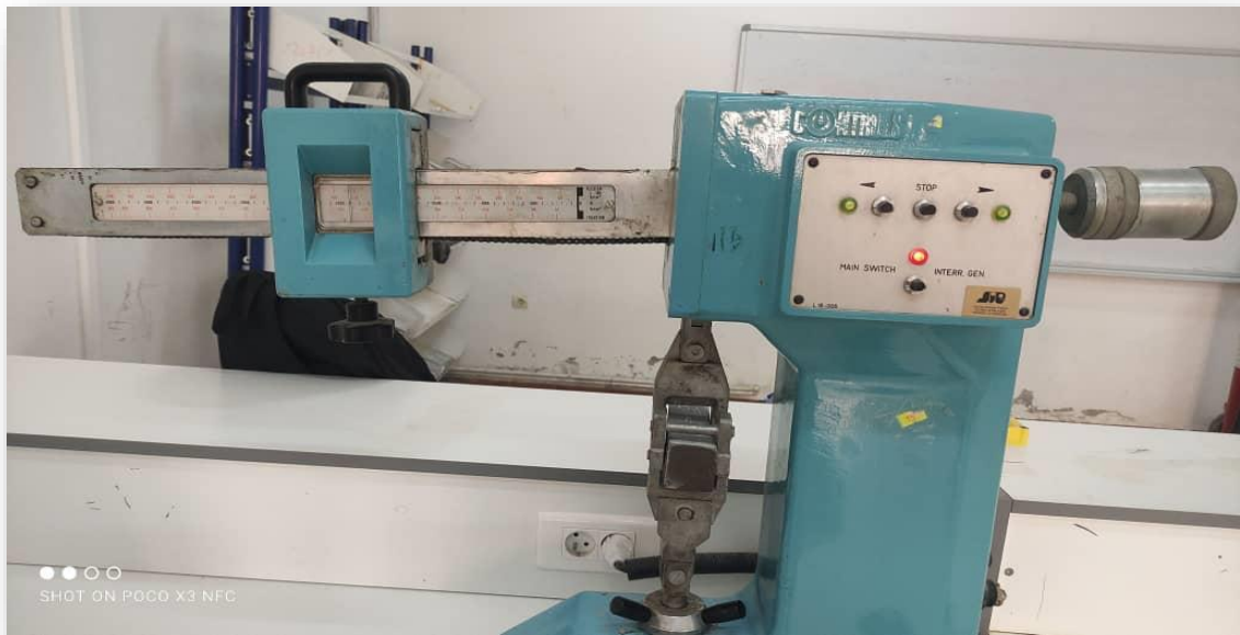
Figure (II.21) : Dispositif pour l'essai de résistance à la flexion.
