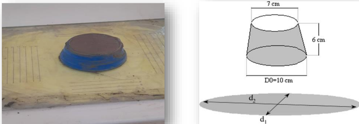
Figure (I-6):Dimensionsde Minicôneàmortier.
