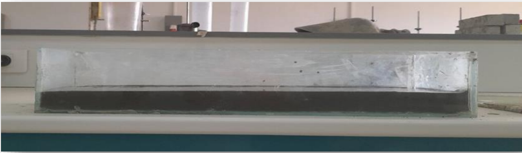
Figure (II.17) : Photo montrant la planéité de la surface libre du MAP**02.
