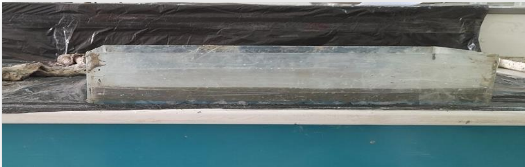
Figure (II.11) : Photo montrant la planéité de la surface libre du MAP04.
