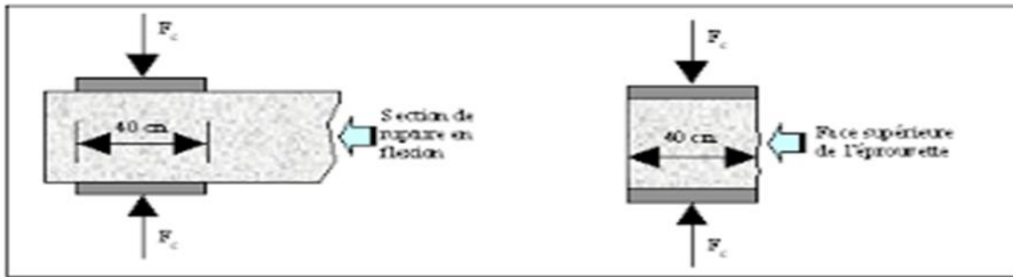
Figure (II.23) : Dispositif pour l'essai de résistance à la compression.
