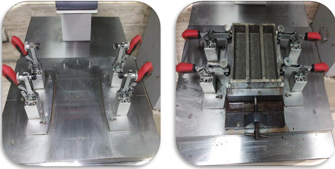
Figure IV-14 : Table à choc (Laboratoire de lafarge M'sila).
