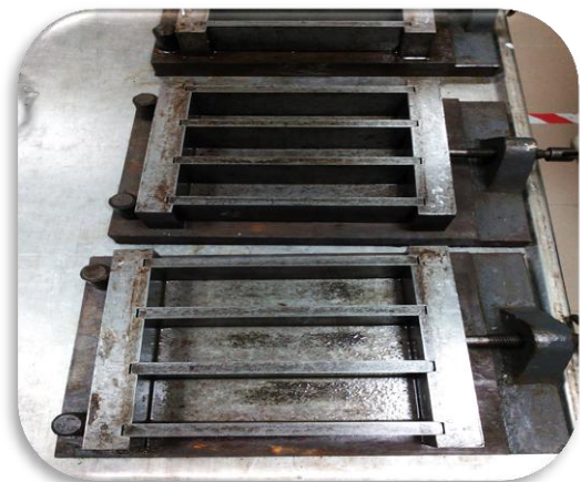
FigureIV-13 : Eprouvette prismatique (4x4x16) cm 3 (Laboratoire de lafarge M'sila)
