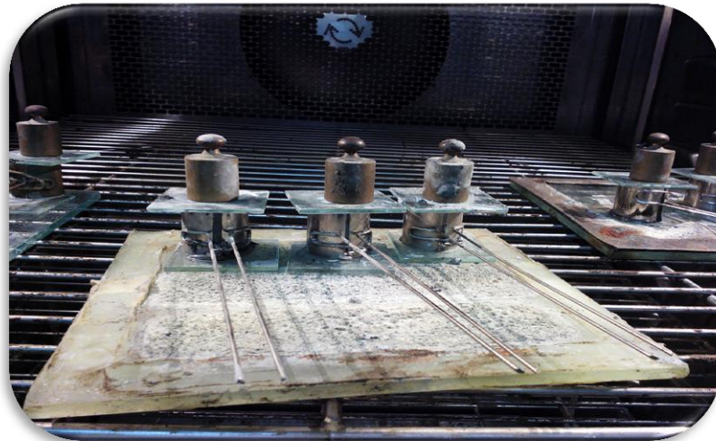
Figure IV-9 : Les aiguillé de chatelier dans armoire.
