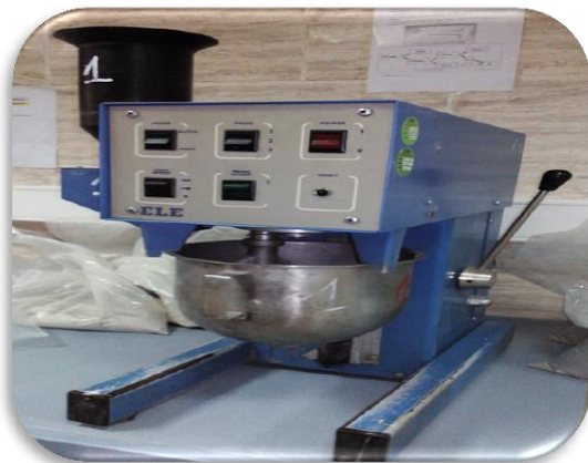
FigureIV-12 : Malaxeur semi-automatique de mortier (Laboratoire de lafarge M'sila)
