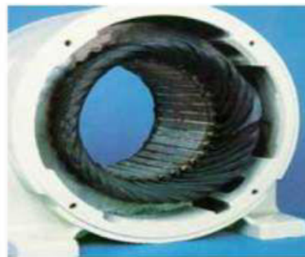
d) Damage dû à la surcharge
