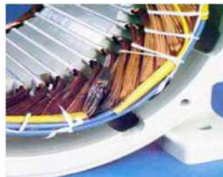
f) Dégradation causée par une surtension
