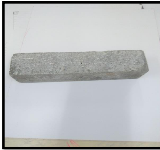
Figure III.6: Texture poreuse des mortiers à base de déchet d'aluminium.
