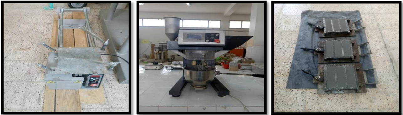
Figure II.4: Appareillage de confection des éprouvettes.
