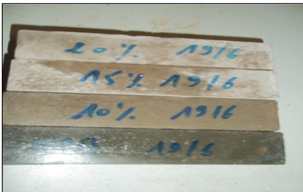
Fig. IV-45. Eprouvettes de mortier après 300 cycles de gel/dégel.
