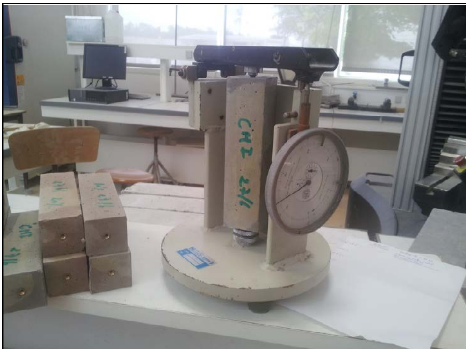
Fig. III-18. Evaluation du retrait/gonflement des éprouvettes de mortier.
