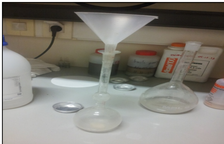
Fig. III-8. Pycnomètre utilisé pour l'évaluation de la masse volumique.
