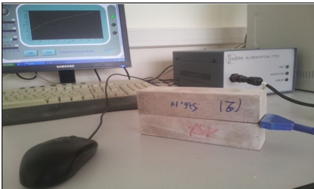
Fig. III-19. Dispositif de mesure de la conductivité thermique des mortiers par fil chaud.
