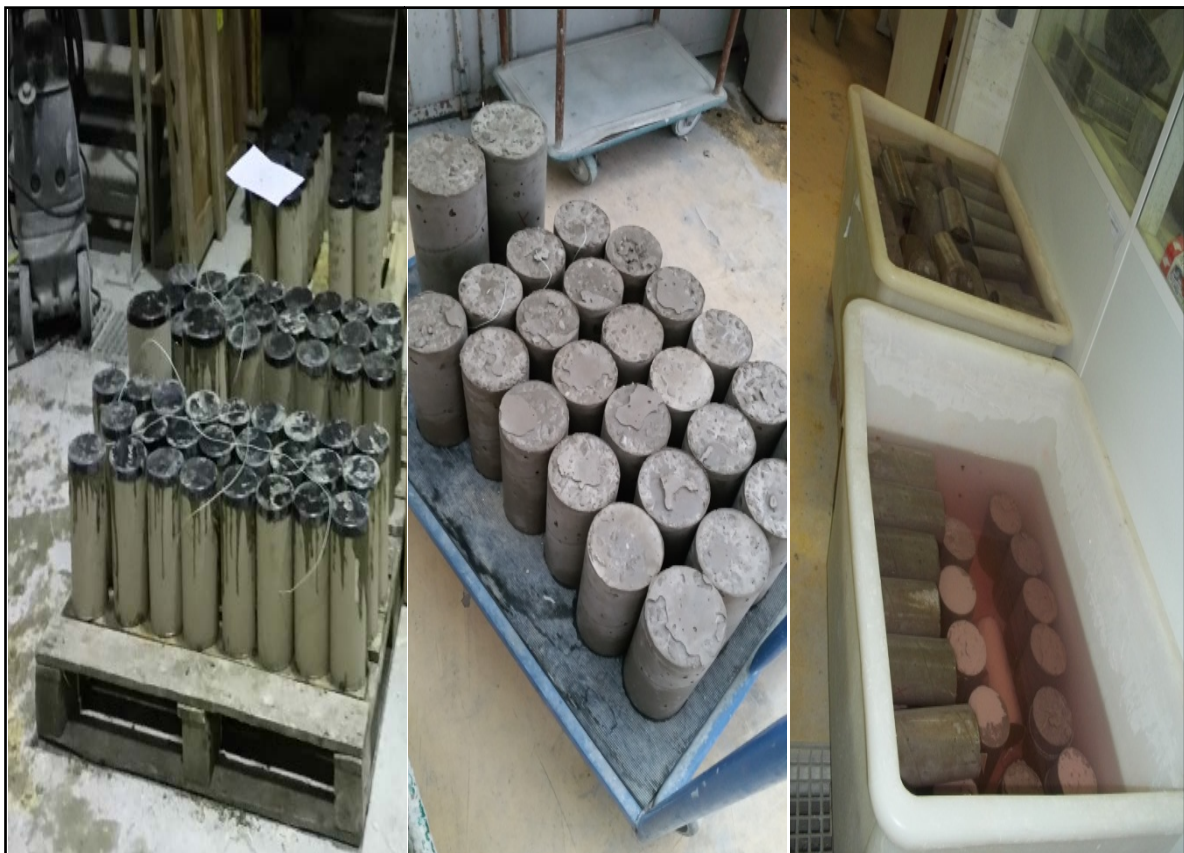
Fig. III-23. Coulage, démoulage et conservation dans l'eau des éprouvettes de béton.
