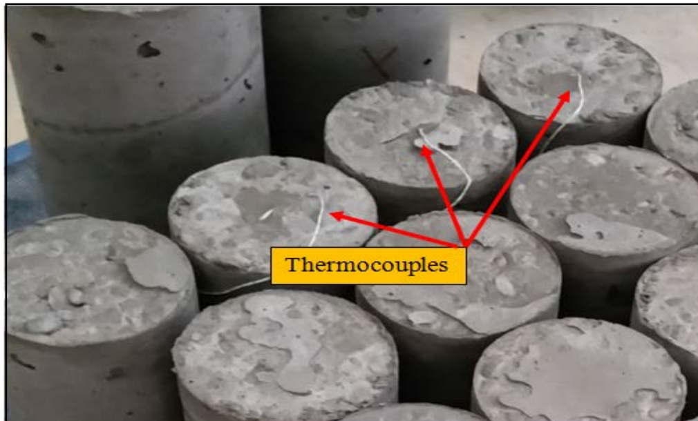
Fig. III-28. Eprouvettes de béton 11*22 cm munies de thermocouples.
