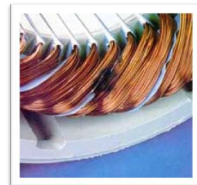
Courts-circuits entre – phase.
