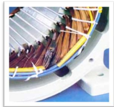
Dégradation causée par une surtension.
