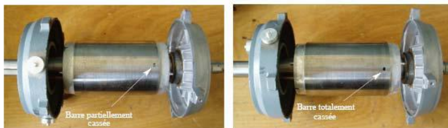
Fig. I.9. Défaut d'une barre cassée.
