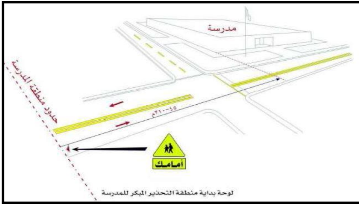
الشكل رقم(26): منطقة التحذير المبكر أمام المدارس.
