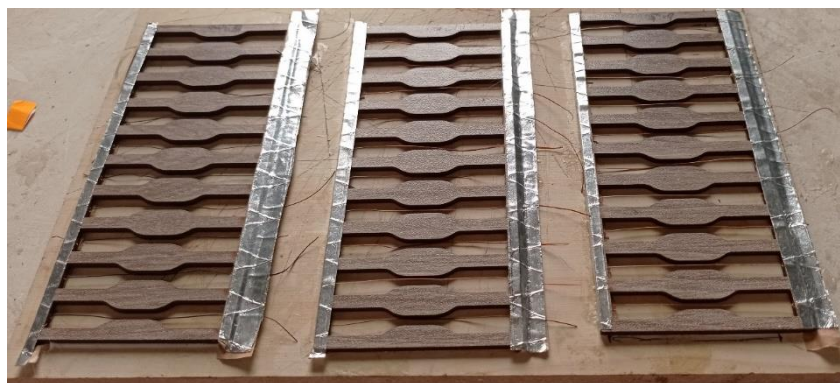
Figure. III. 7. Moule pour éprouvette de traction des composites monofilaments.
