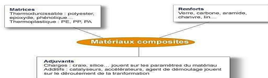
Figure I. 2 : Constituants d'un composite
