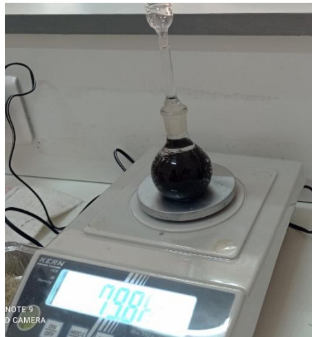
Figure. III. 10. Mesure de la densité
