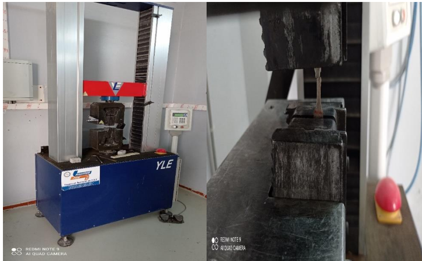
Figure. III. 13 : Eprouvette soumise à la traction.
