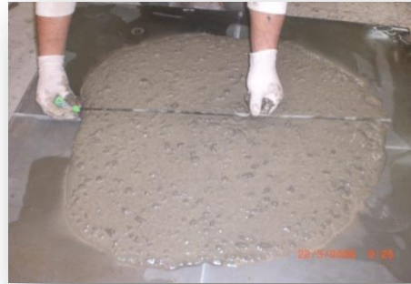
Figure IV.8 Essai d'étalement au cône.
