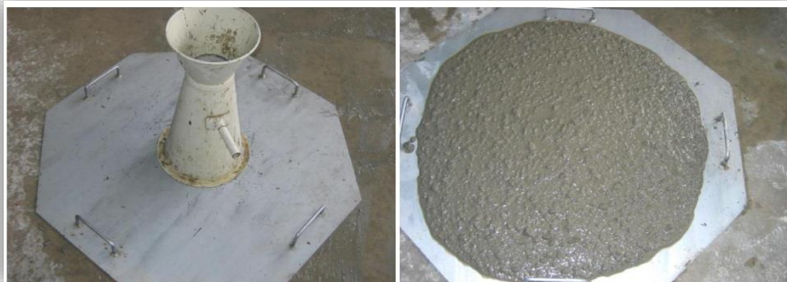
Figure I.6 Mesure de l'étalement des BAP.
