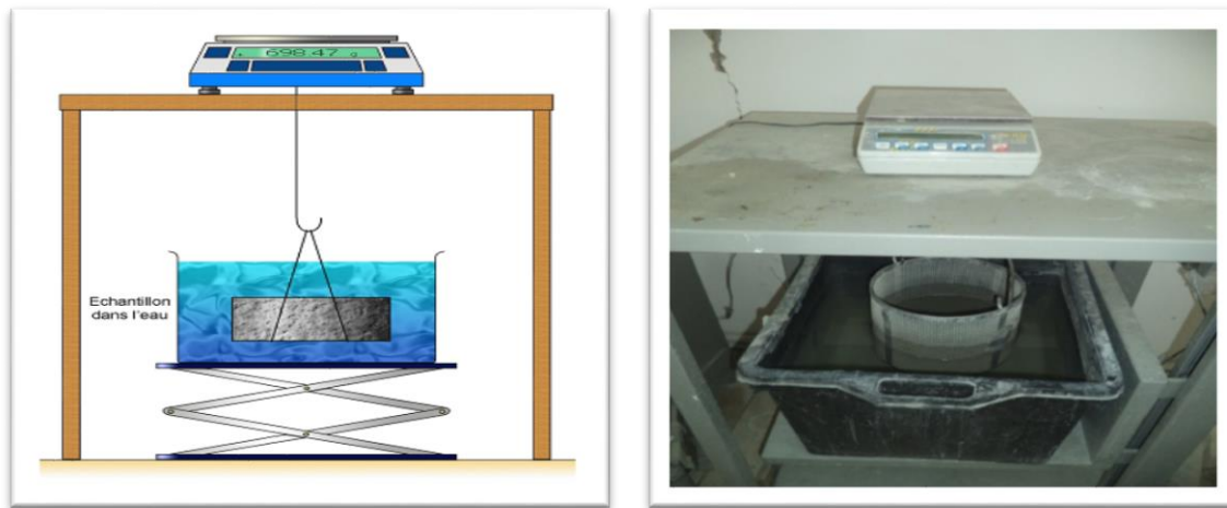
Figure IV.13 : Essai de porosité à l'eau.
