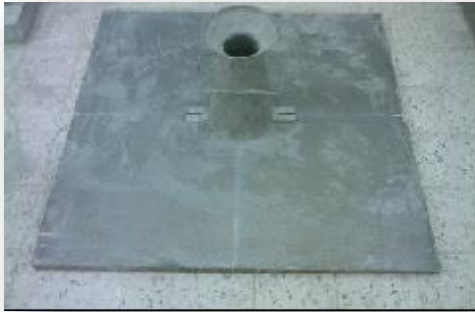
Figure IV.8 Essai d'étalement au cône.
