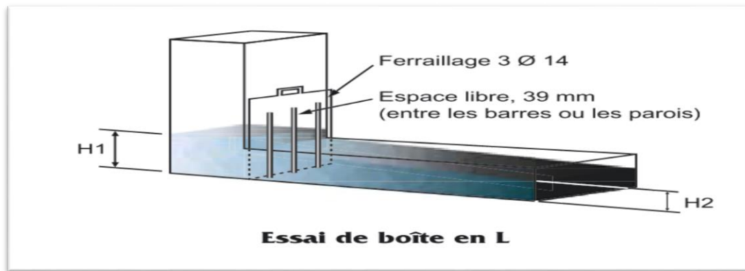
Figure IV.11 Essai de la boîte en L.
