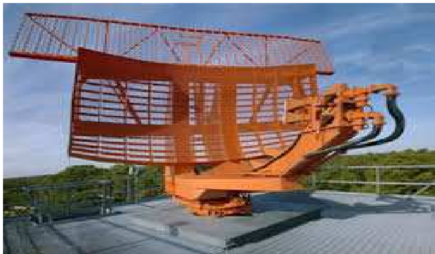
Figure 1. 3 Radar primaire typique à faisceau plat d'un aéroport.
