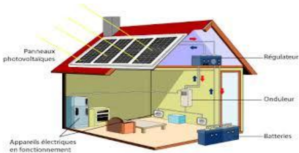
Fig16. Système PV autonome
