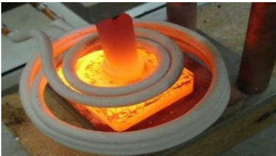
Figure I—8 recuits acier et normalisation par induction.
