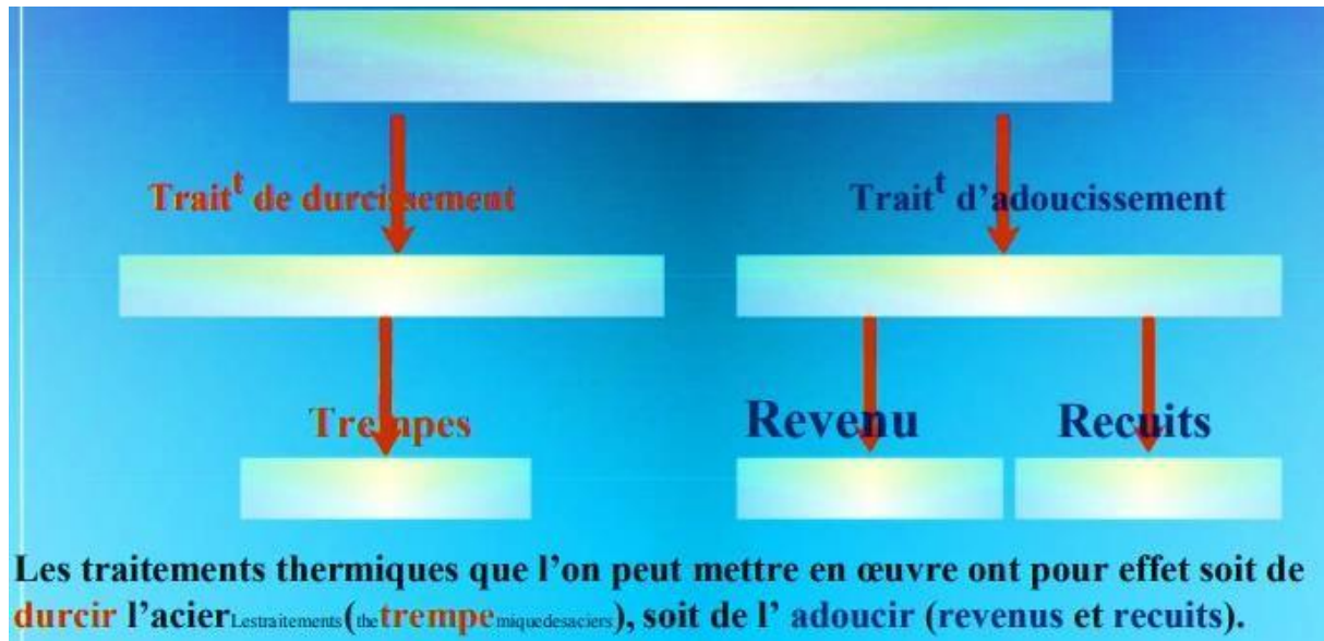
Figure I—5 une image présente les traitements thermiques des aciers
