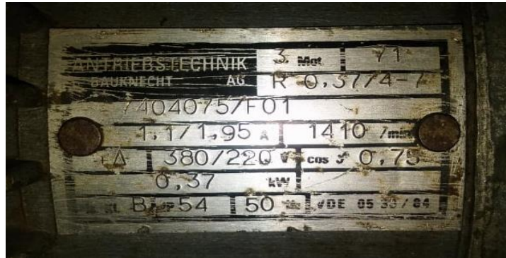
Figure III.3: photographie de la plaque signalétique de notre machine
