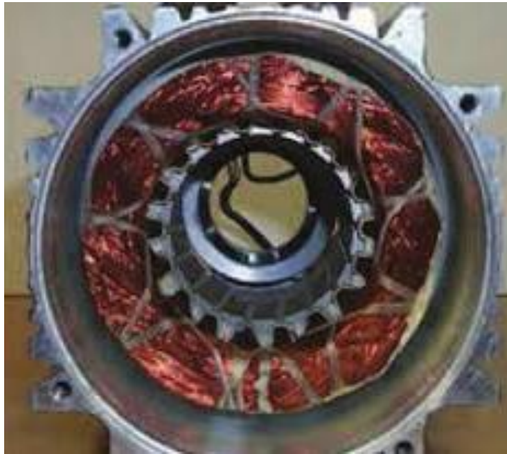
Figure I.2 : photographie d'un stator
