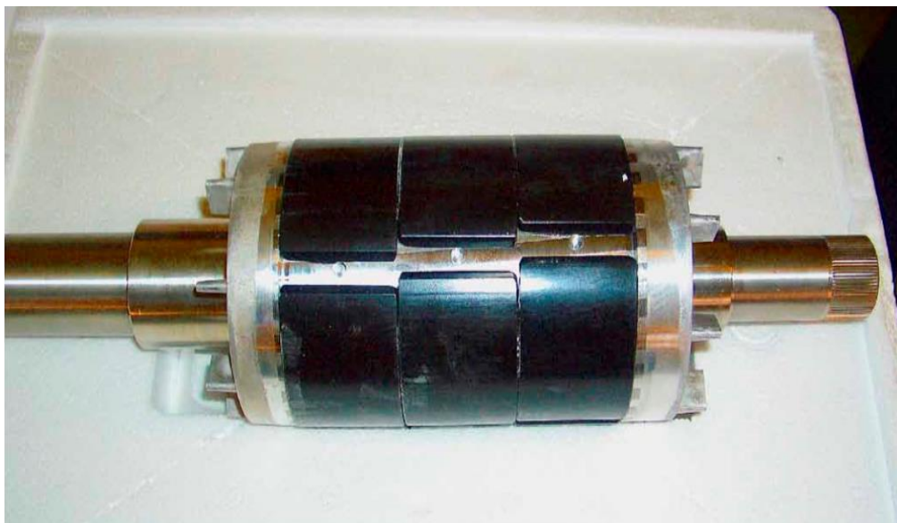
Figure I.3 : photographie d'un Rotor avec des aimants
