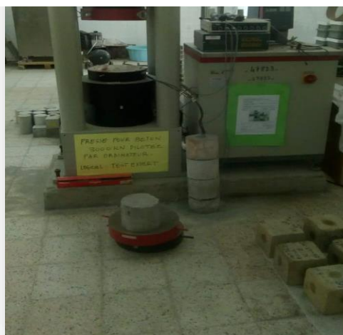
Figure IV. 5: Presse hydraulique pour l'essai de compression (avec une pression de 300KN).
