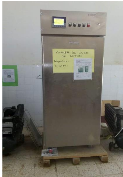
Figure IV. 4: l'étuve utilisée pour la cure (du laboratoire de développement Géomatériaux université de M' sila).
