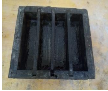
الشكل(31): القالب المستعمل في اختبار الثني والضغط.
