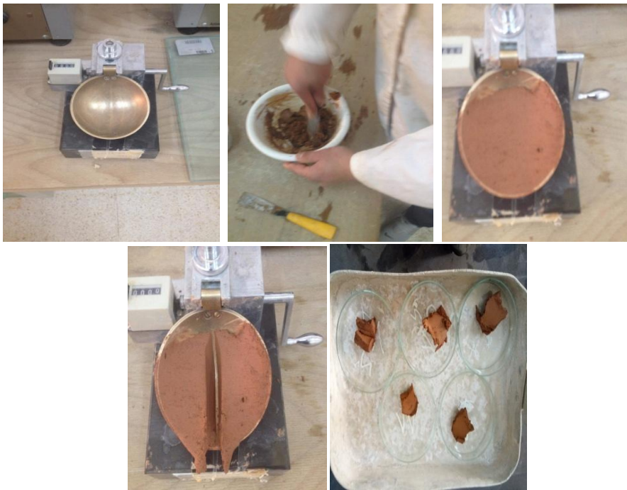
الشكل (29): خطوات قياس حد السيولة.
