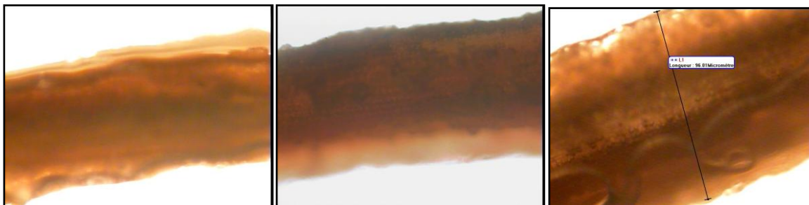
الشكل (39): صورة بالمجهر الضوئي لألياف النخيل غير المعالجة (P0000).
