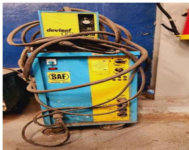
Figure IV.3: Poste à souder a l'arc électrique utilisé.
