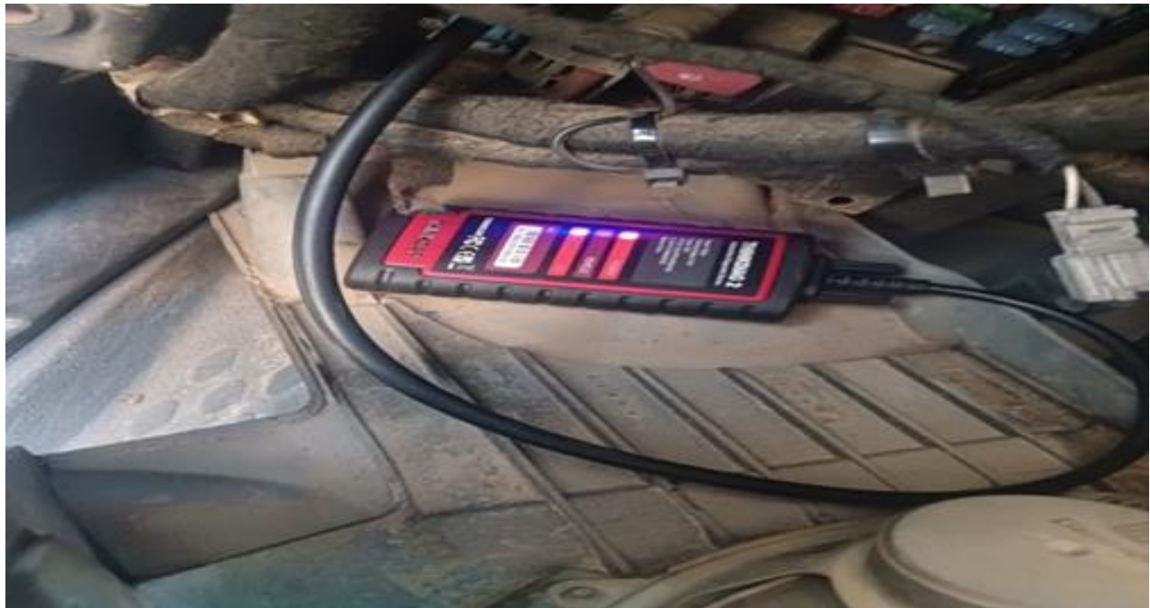
Figure IV-12.Connexion de thinkdiga2 à la fiche OBD.
