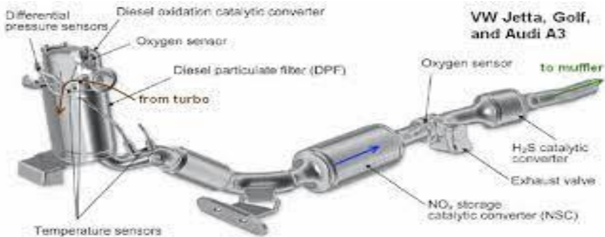
Figure II-16. Schéma globale de circuit d'échappement.
