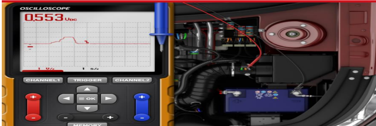
Figure III -10. Teste de capteur de débit d'air [21].
