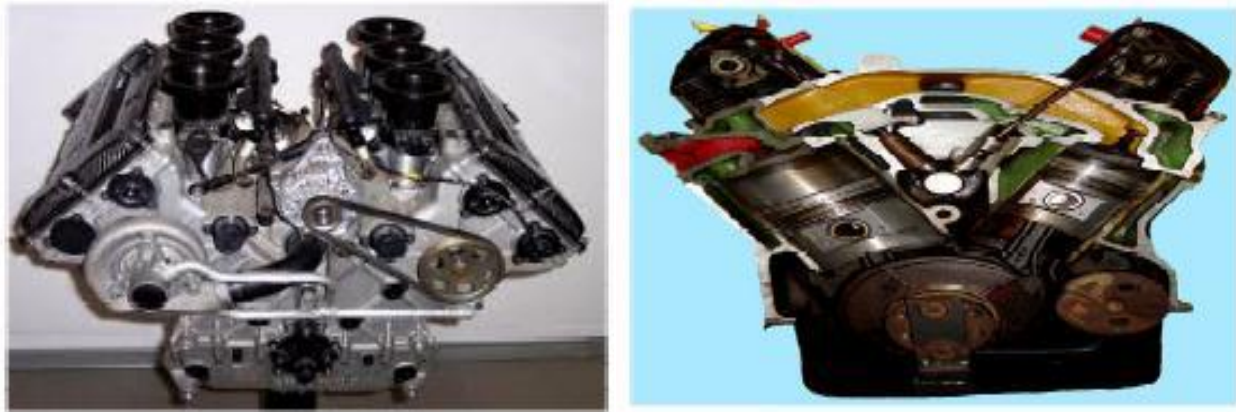
Figure I-18. Moteur classique à combustion interne avec cylindre en V. [2]
