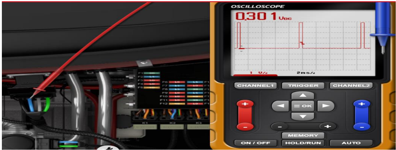
Figure III-8. teste de capteur pédale d'accélération[21].
