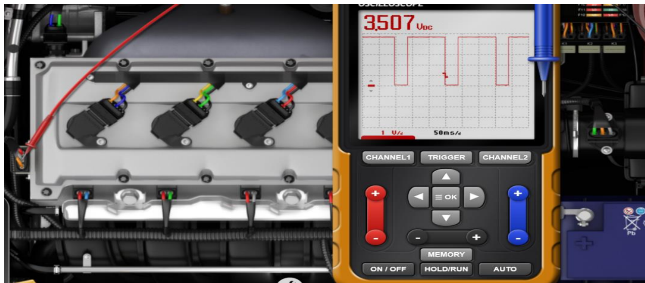
Figure III-20. teste de capteur d'arbre came.
