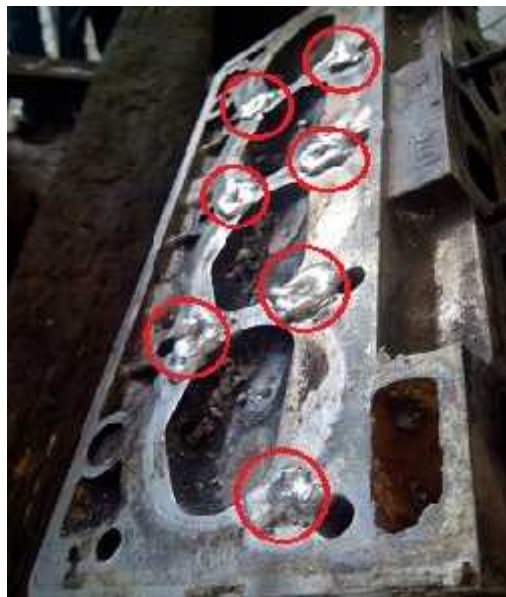
Figure III.3. Rechargement des zones défectueuses.
