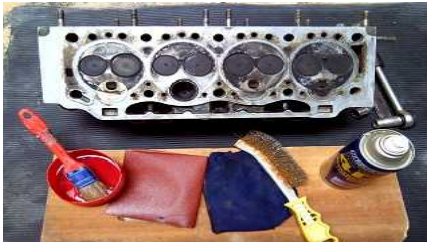
Figure. III.1. Nettoyage et inspection du culasse.
