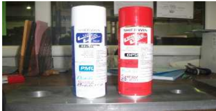
Figure III.8. Les produits (pénétrants et révélateurs).
