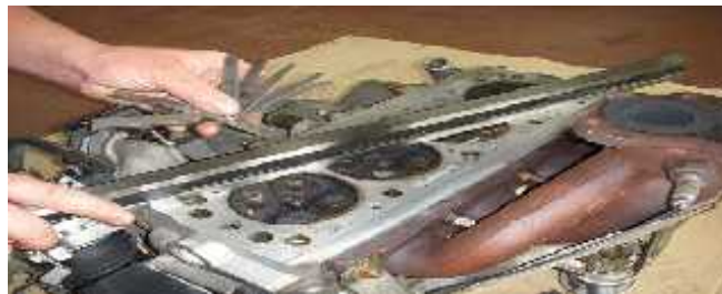
Figure III.5. Contrôle de la planéité.
