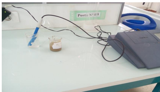
Fig. n° 39 Détermination de pH du sol.
