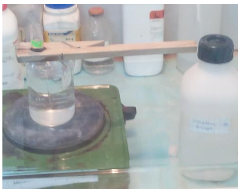
Fig. n° 37 : Chauffage de fixateur de Grise dans un bain marie.
