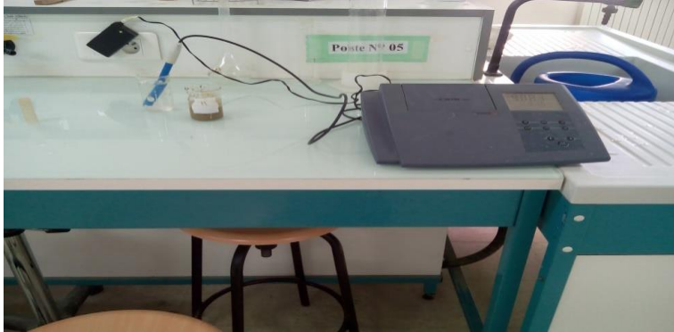
Fig n°40 Détermination la conductivité électrique (CE)
