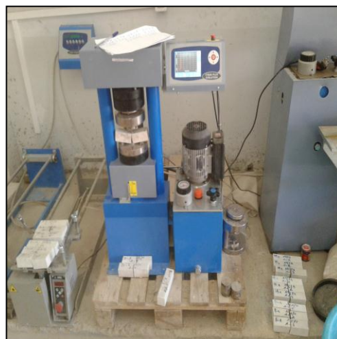
Figure III.10. Appareil de compression et de flexion
