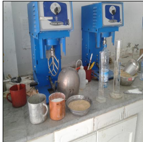
Figure III.7. Malaxeur pour mortier.
