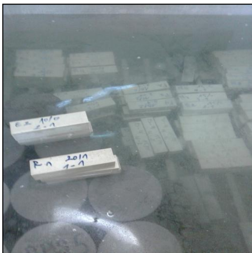
Figure III.8. Conservation des éprouvettes dans l'eau.
