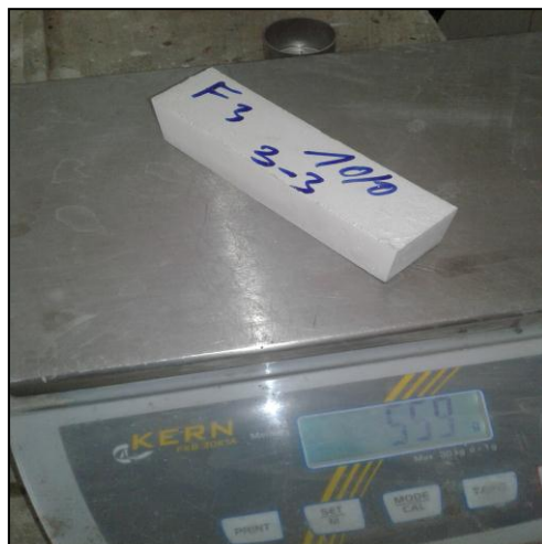
Figure III.9. Pesage des éprouvettes
