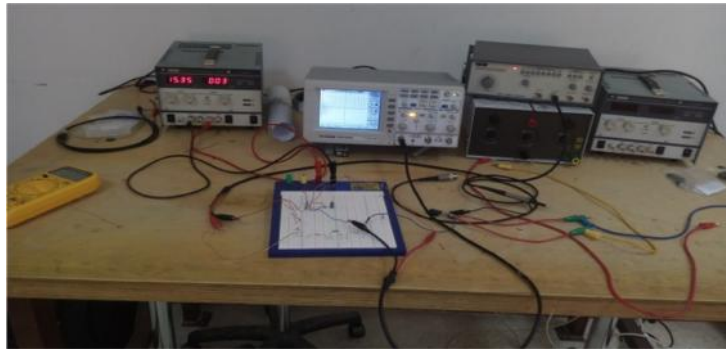
Figure.III.9. Montage du test du circuit de pilotage du mosfet.
