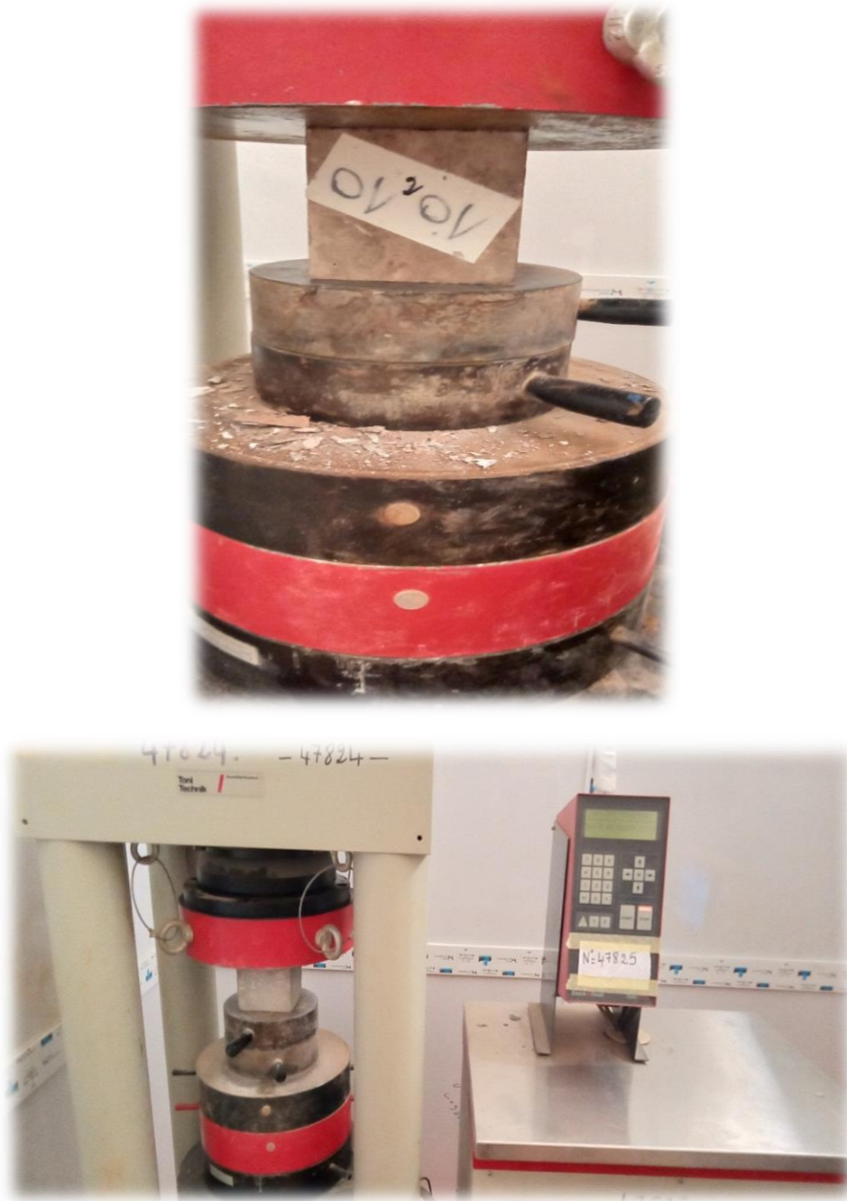
Figure II. 20 : La machine pour essai de compression et affichage de la résistance (la machine de laboratoire de Géo-matériaux).
