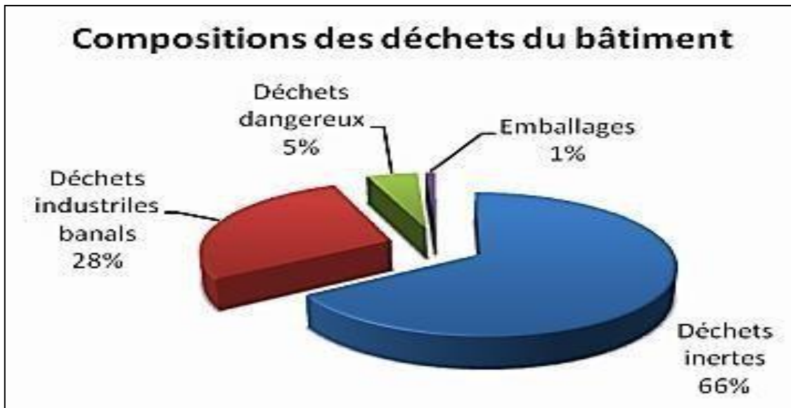
Figure I.2 : Compositions des déchets du bâtiment.
