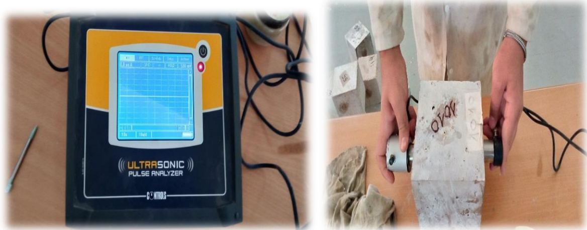
Figure I.31 : Essai d'ultrason (ultrason de laboratoire de Géo-matériaux).
