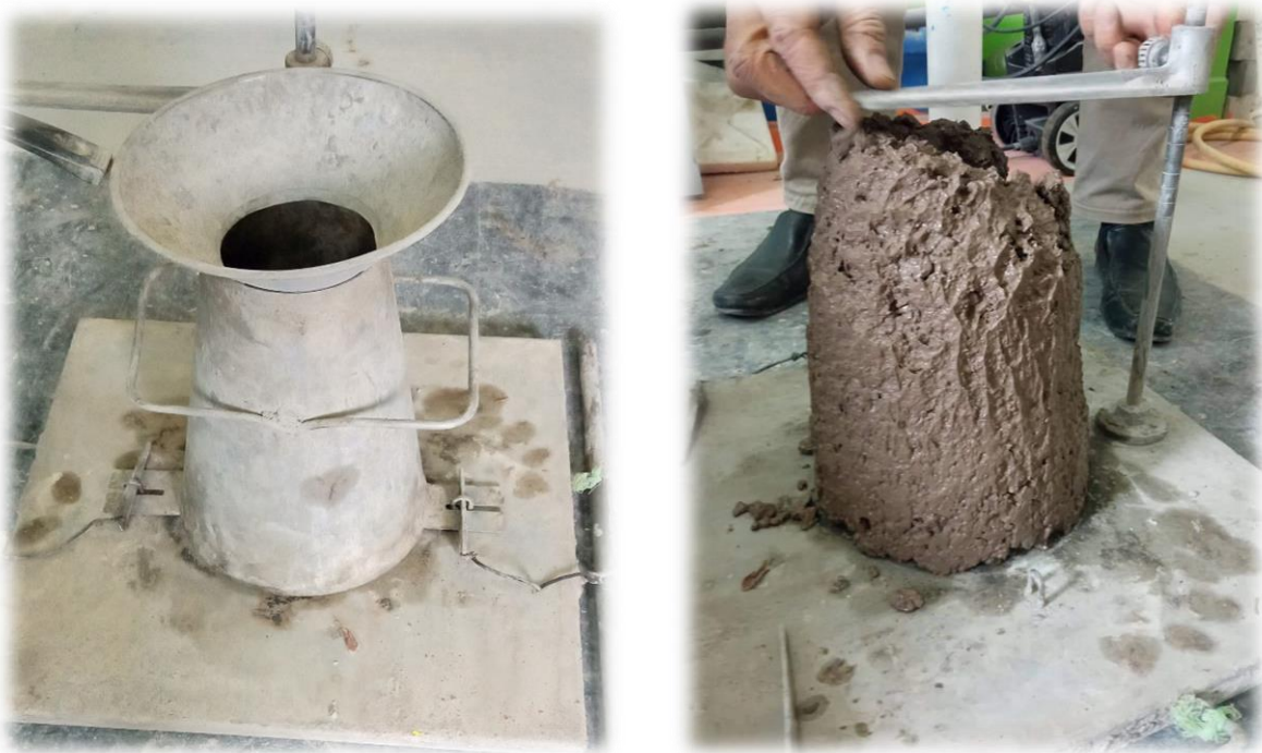
Figure II. 15 : l'affaissement de cône d'Abrams d'un béton.
