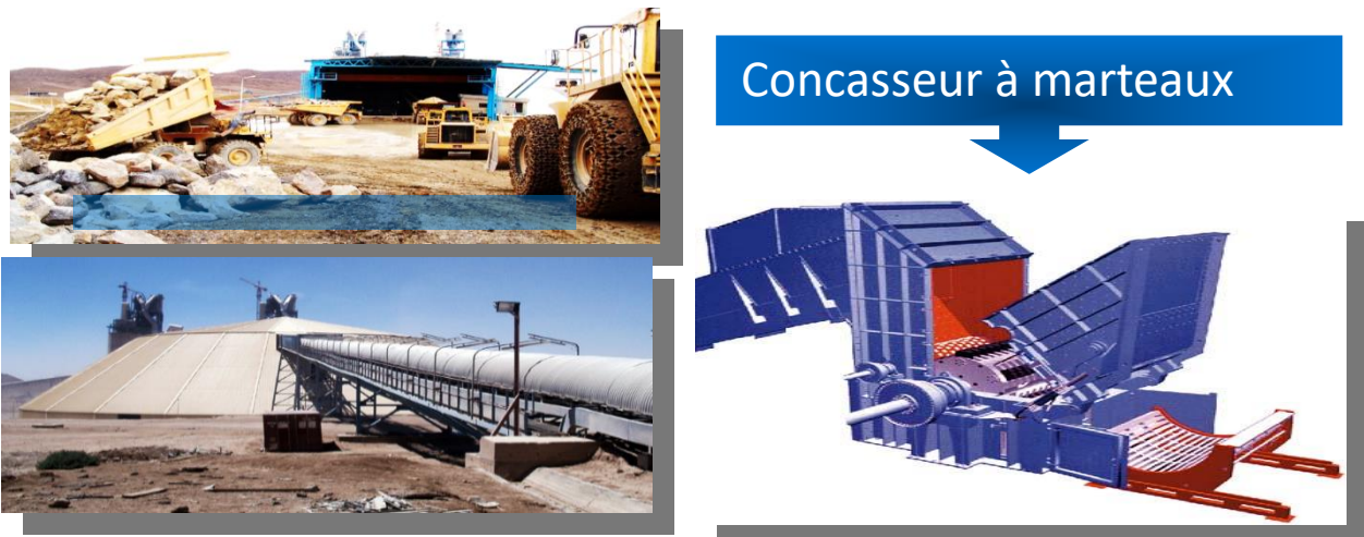
Figure.11. Le concasseur à marteau et le transport vers le hall d'homogénéisation de la matière crue [71].
