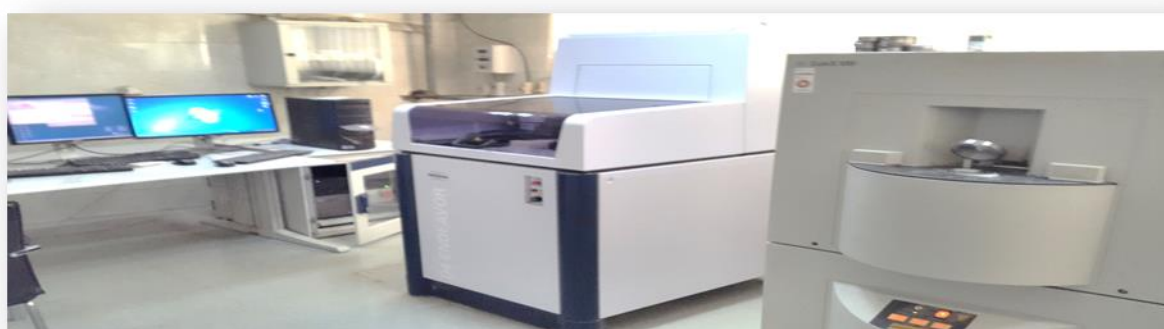
Figure.19. Appareil d'analyse Diffractométrie Rayon X (DRX) et l'appareil d'analyse fuorissance X (FX) [71].
