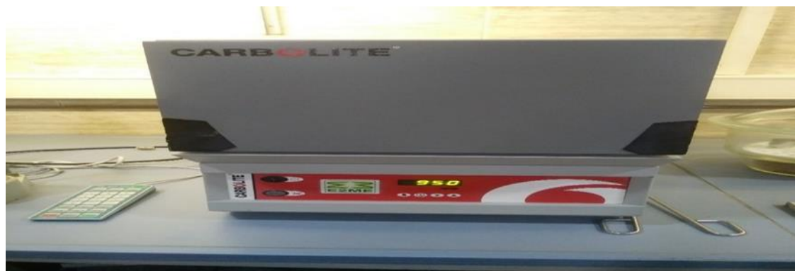
Figure.18. Calcinateur de marque CARBOLITE [72].
