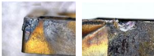
FIG. IV.10-Rupture mécanique d'une plaquette [89].
