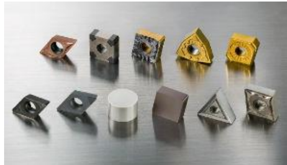
Fig.II.2-Matériaux pour outils de coupe [34].
