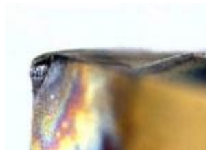
FIG. IV.9-Formation d'entailles d'une plaquette [89].
