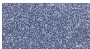
Fig.II.8-Grain WC de taille moyenne à grosse [33].
