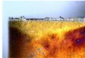
FIG. IV.6-Écaillage d'une plaquette [89].
