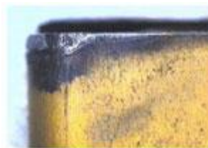
FIG. IV.4 -L'usure en dépouille normale [89].
