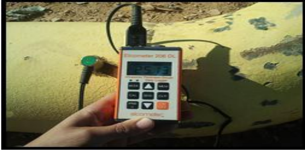
Figure(4.4): principe de mesure avec UT
