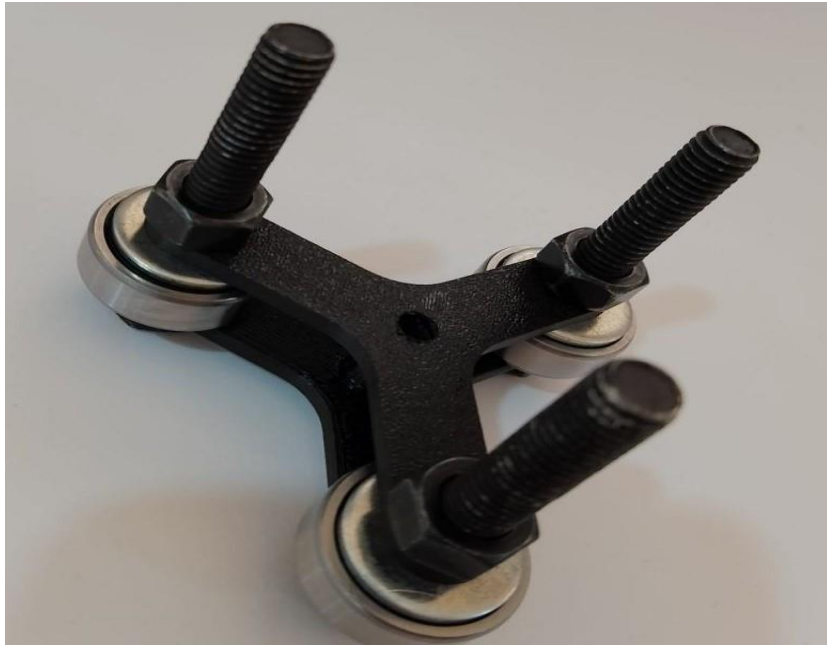
Figure 25 Assemblage 1 de Rotor avec les roulements à billes à l'aide d'une vis et d'un écrou en réel.
