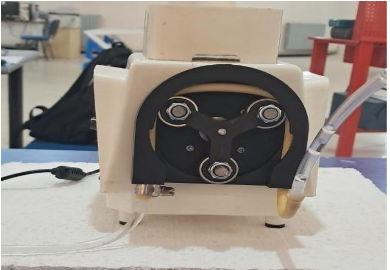
Figure 31 rototype de l'assemblage du dispositif de la pompe péristaltique
