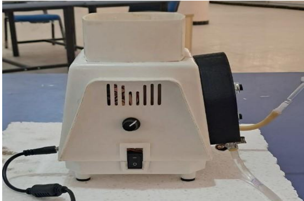
Figure 32 Dispositif de réglage de la vitesse et mise en marche/arrêt
