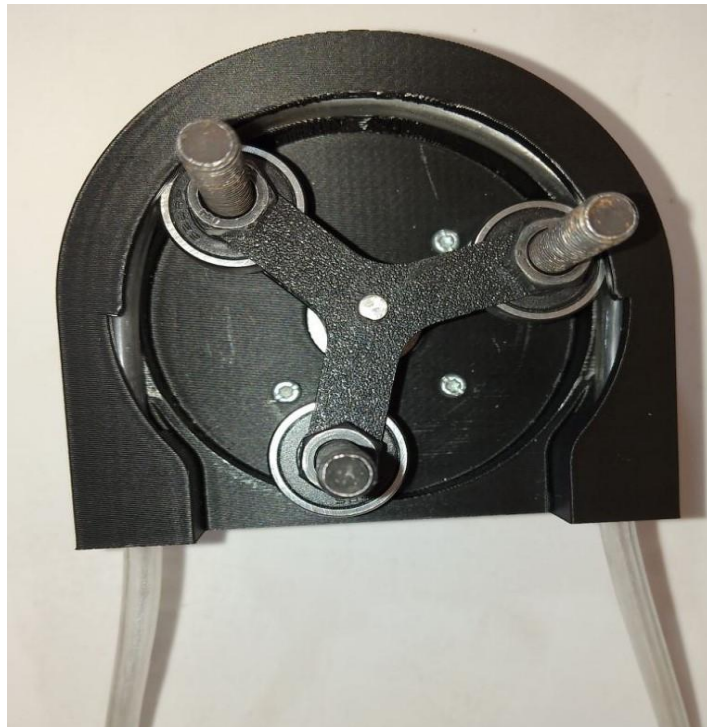
Figure 26 Assemblage 2 du rotor avec roulements à billes, vis, écrou et tuyau réel dans le corps de la pompe
