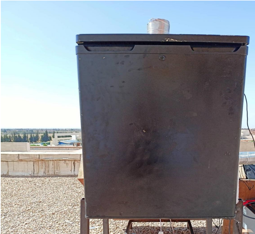
Fig. 3.3 Chambre de séchage
