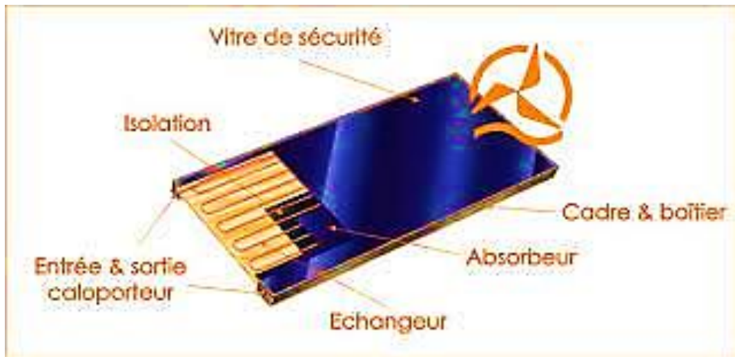
Fig. 2.4 Capteur plan
