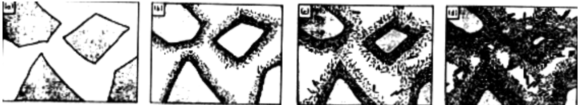
Figure 1-14. Modèle schématique de la formation de la structure dans la prise de la pâte de ciment [19,21].
