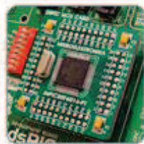
CPU 64 ou 80 broches (dsPIC30F6014A livré)
