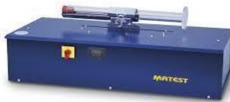
Figure IV.5 : Essais d'équivalent de sable.
