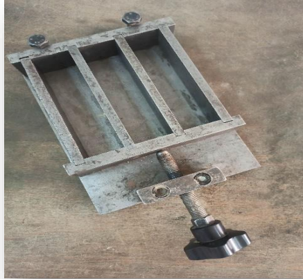
Figure IV.14 : Moule d'éprouvette prismatique (4*4*16).
