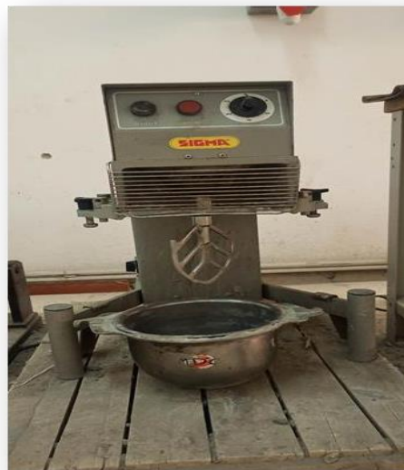
Figure IV.11 : Le malaxeur utilisé (malaxeur de laboratoire Géo-matériaux).
