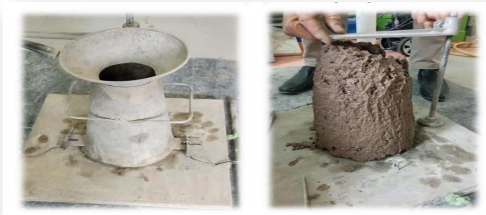
Figure IV. 12 : l'affaissement de cône d'Abrams d'un béton.
