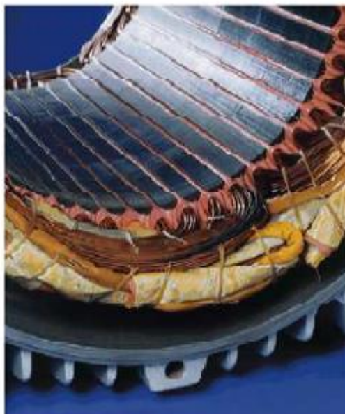
Figure II.5 - court-circuit entre spires de la même phase
