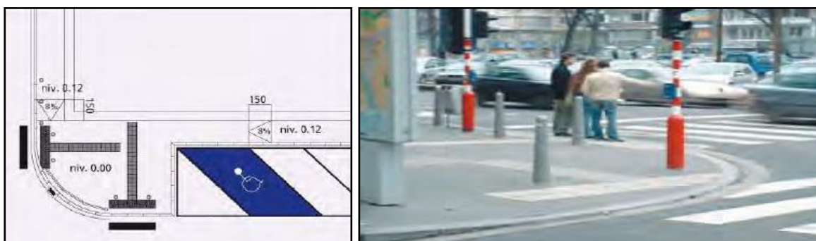
Schéma 09 : vue en plan d'une photo 02 : vue en plan d'une inflexion généralisée Inflexion généralisée
