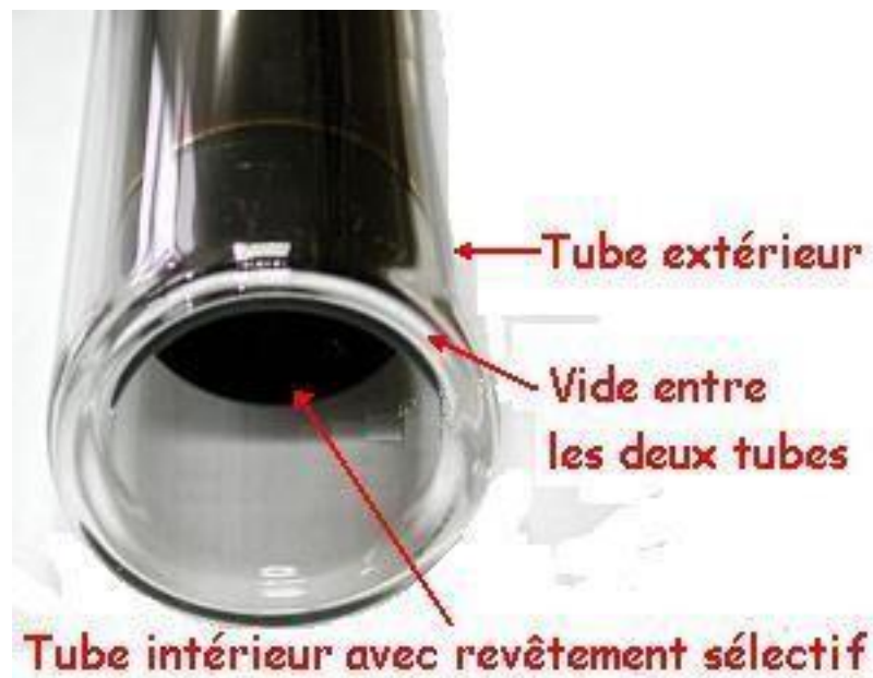
Figure III .8. Les capteurs à tube sous vide à effet “thermos”
