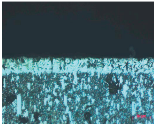
FigureV.8 /e: observation au microscope optique d'une Couche de chrome sure Substrat 100C6 traité à 1100°C X 500.
