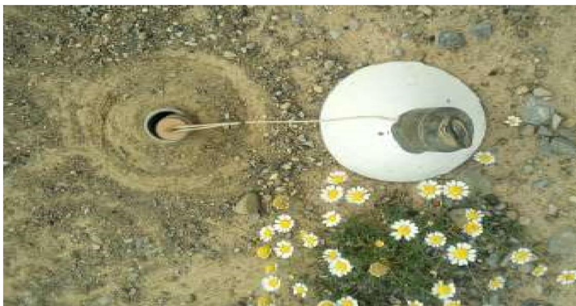
Figure(III.16): Mesure de la température du sol à la station de Msila.
