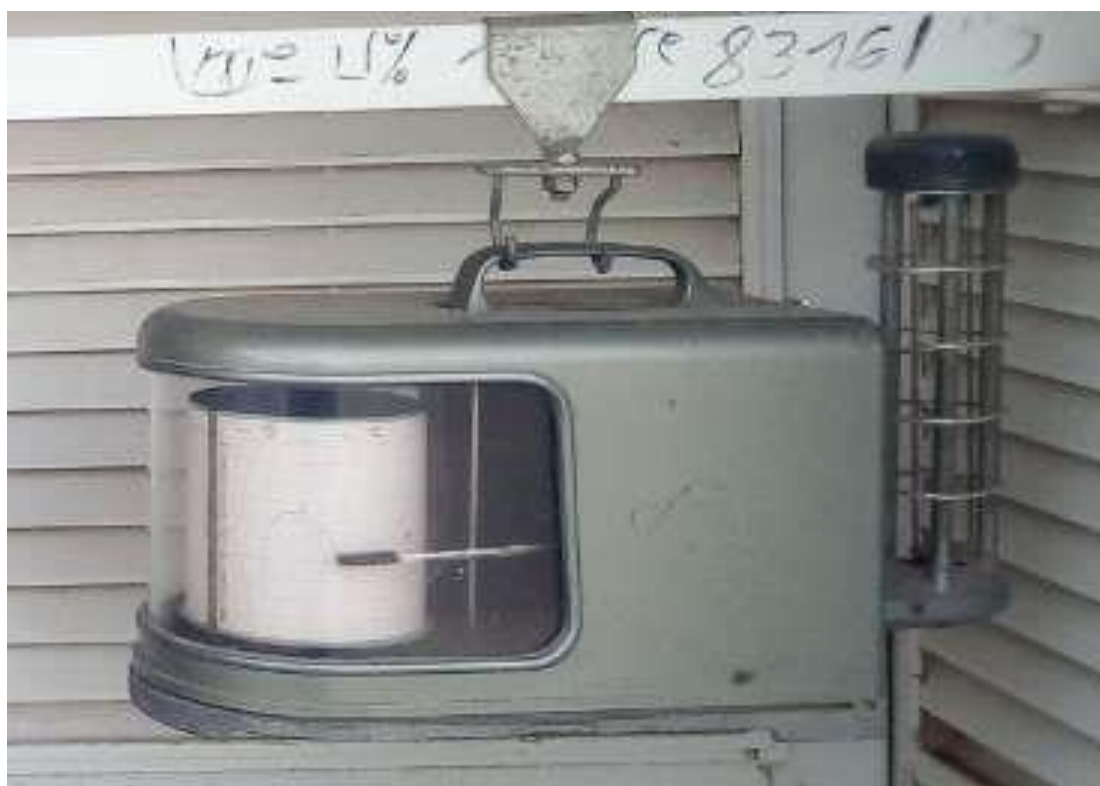
Figure(III.11): Hygro-graphe de labri météorologique de Msila.
