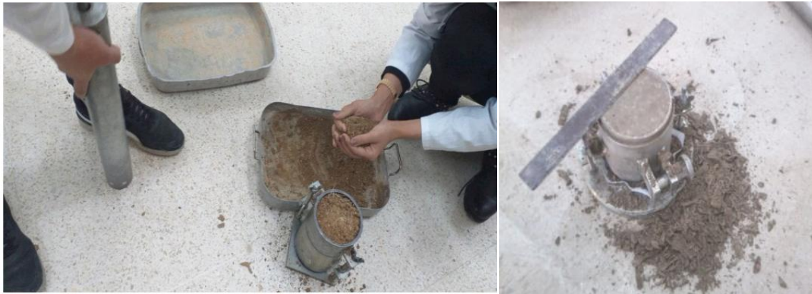
Figure II.18 : Compactage de l'échantillon. Figure II.19 : Le surplus est arasé
