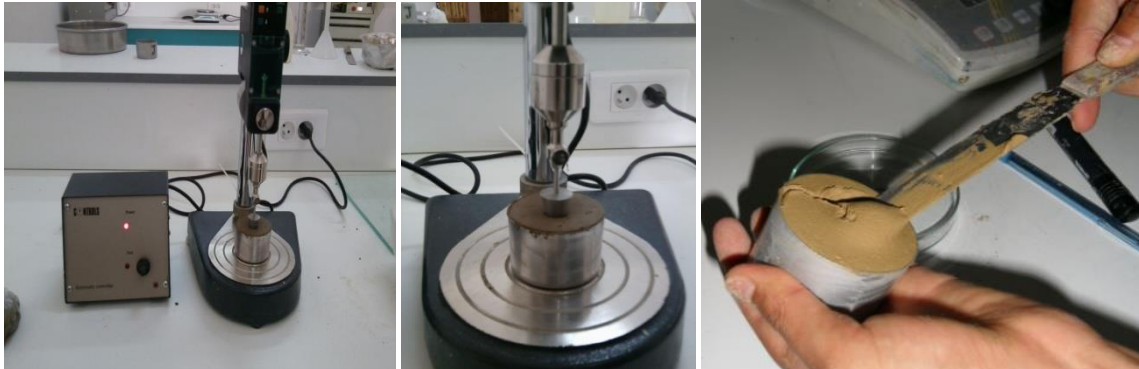
Figure II.8. Pénétrömètre à cône Figure II.9 Enfoncement Figure II.10 Prélèvement d'un Du cône. échantillon.
