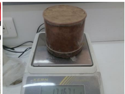
Figure II.13 : Peser le récipient Figure II.14: Règle et araser. Figure II.15: Peser le récipient Rempli.
