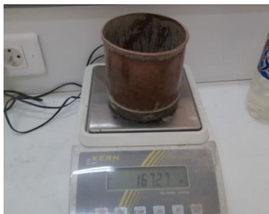
Figure II.13 : Peser le récipient Figure II.14: Règle et araser. Figure II.15: Peser le récipient Rempli.
