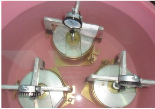
Figure II.21 : Imbibition des échantillons (essai CBR).
