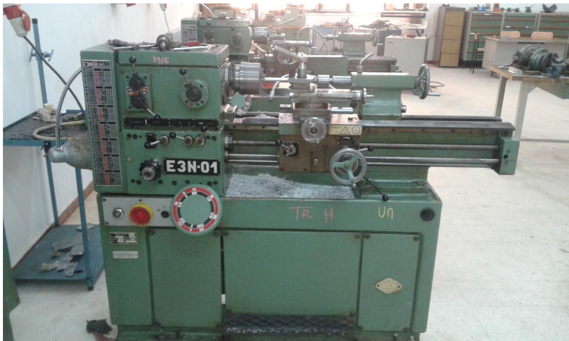
Figure 3.1 Le tour E3N-01 utilisé pour le soudage par friction.
