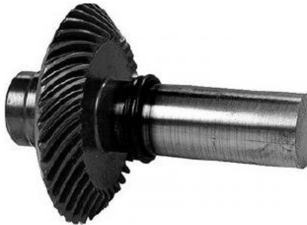
Figure 1.10 – (b) Engrenage soudé par friction.
