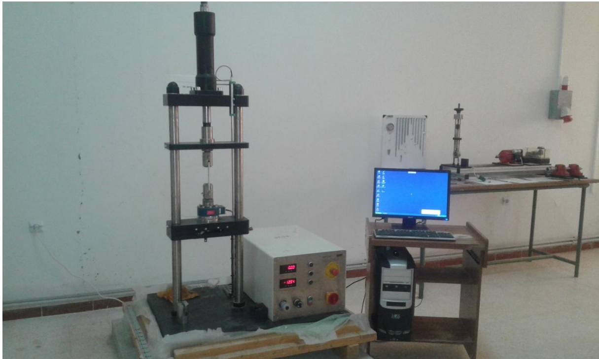
Figure 3.2 La machine WP 310 utilisée pour l'essai de traction.
